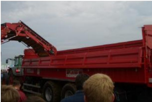
Absenkbare Bordwand für tieferes „Eintauchen“
